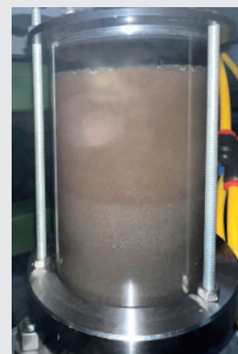
鐵屑沈積狀況
